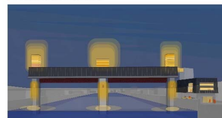
照明の点灯によって、上流側下流側同時、あるいは個別の点灯でその表情が変わります。 全点灯、明瞭な点灯、連絡点灯、門柱の点灯等、組み合わせで、様々なシーンで演出が可能となります。
