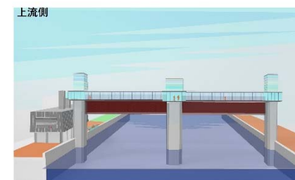
出港時、上流側から見る 二段式ローラーゲートは巻揚時の見付け面積が小さく閉塞感の解消が出来ます。
